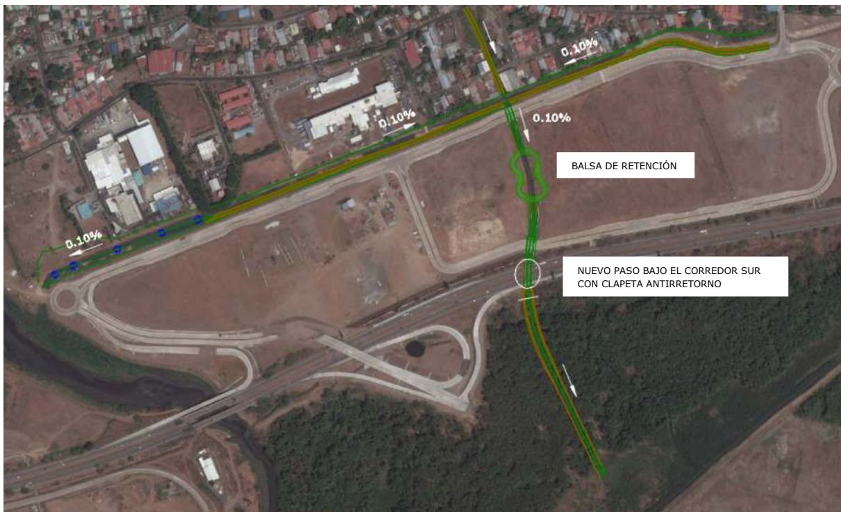
Figura 23. Detalle de los elementos constituyentes de la solución de drenaje general de la zona sur de Ciudad Radial y Metro Park. Zona Oeste.
