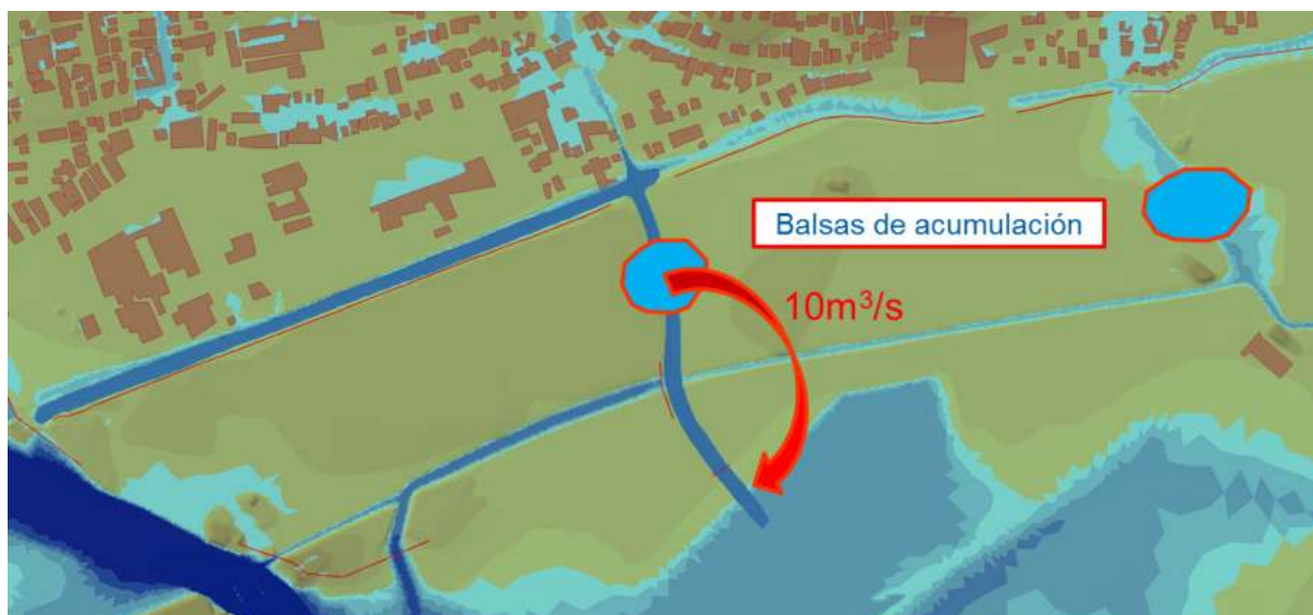
Figura 26. Balsa de acumulación y esquema de bombeo contra eventos de inundación durante fases de pleamar.
