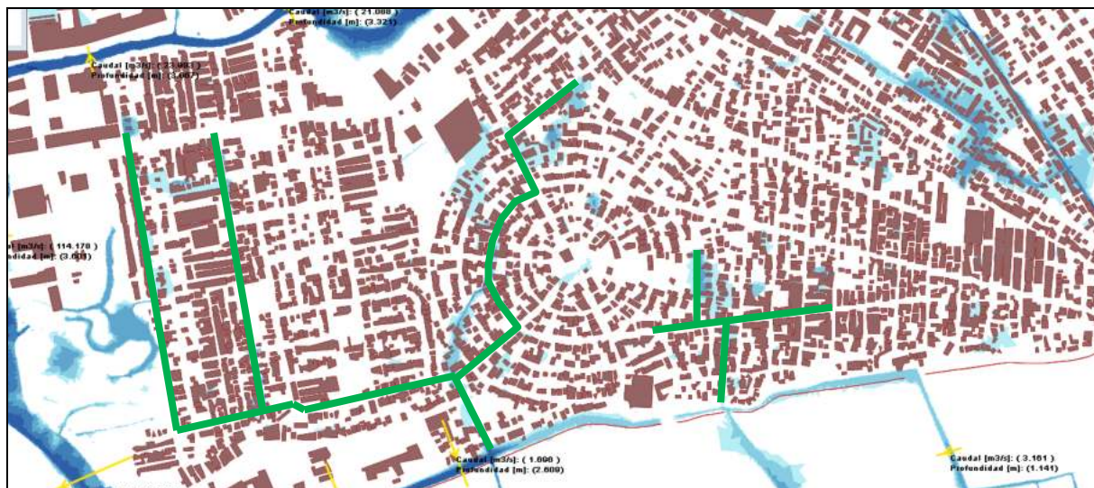
Figura 28. Representación esquemática de la red de colectores (líneas verdes) en la zona urbana de Ciudad Radial. Drenaje de la zona de Santa Inés hacia canal de Metro Park.
