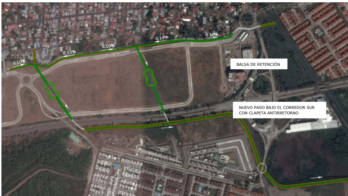
Figura 24. Detalle de los elementos constituyentes de la solución de drenaje general de la zona sur de Ciudad Radial y Metro Park. Zona Este.
